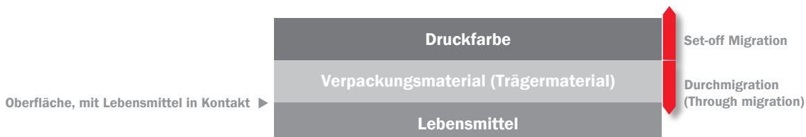
Unterschiedliche Migrationswege: Stoffübertrag durch Abklatsch (Set-Off) und durch Migration aus der Druckfarbe durch den Bedruckstoff („Durch-Migration“)
